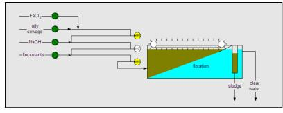
Mit der Automatisierung der Chemikaliendosierung wurden die Chemikalienkosten deutlich gesenkt. Die optische Kontrolle der Chemikaliendosierung hat die Bedienungsfreundlichkeit und die Betriebssicherheit der Anlage erhöht. Die **ARU**-Dosiersteuerungen sind in das vorhandene Pro-
